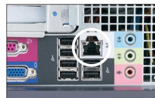
Puerto Ethernet en el panel posterior de la CPU del ordenador de IDEXX VetLab Station
