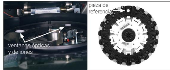
8. Utilice una toallita seca para instrumentos ópticos aprobada por IDEXX para secar las ventanas ópticas y la pieza de referencia, asegurándose de que todo rastro de humedad se haya evaporado de los componentes limpiados. Si quedan bandas o manchas, repita el proceso de limpieza.
