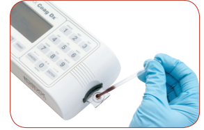
Figura 3: Añada la muestra en el centro del pocillo
