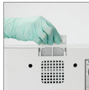
10. Retire el filtro del ventilador, enjuáguelo bien con agua tibia, séquelo con una toalla de papel y vuelva a colocarlo en su lugar en el analizador. A continuación, pulse **Hecho** en la pantalla de la Guía de limpieza de SediVue Dx, para encender la SediVue Dx.
