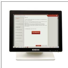
1. En la pantalla de configuración de SediVue Dx, pulse **Limpiar** y luego pulse **Apagar SediVue**.
