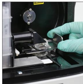
9. Vuelva a colocar el contenedor de residuos, el protector de la centrifuga y el portador de cartuchos en sus lugares correspondientes en el analizador.
