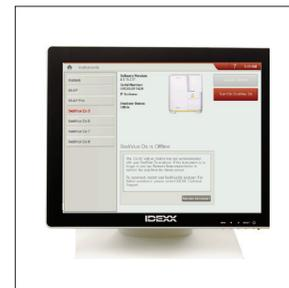
11. En la pantalla de instrumentos de SediVue Dx, pulse **Encender SediVue Dx** para que SediVue Dx se ponga en marcha.
