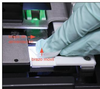
3. Con una toallita impregnada en alcohol nueva, limpie el brazo de alimentación (área de dispensación), incluida la parte delantera del brazo móvil. A continuación, seque los componentes con una gamuza para lentes.
