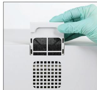
10. Retire el filtro del ventilador en la parte trasera del analizador, enjuáguelo bien con agua tibia, séquelo con una toalla de papel y vuelva a colocarlo en su lugar en el analizador.
