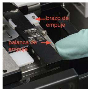
5. Presione la palanca de empuje hacia la izquierda y repita el paso 4 en el lado derecho del brazo de empuje con una nueva toallita preparada con alcohol enjuagada.
