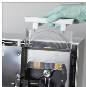
7. Quite el protector de la centrifuga, el contenedor de residuos y la bandeja de goteo. A continuación, limpie estos componentes con agua tibia y séquelos con toallas de papel.
