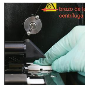
7. Mueva suavemente el brazo de la centrifuga hacia la izquierda e inspeccione la zona inferior en busca de residuos. Si está sucia, utilice una nueva toallita preparada con alcohol para limpiarla y luego séquela con una nueva gamuza para lentes.
