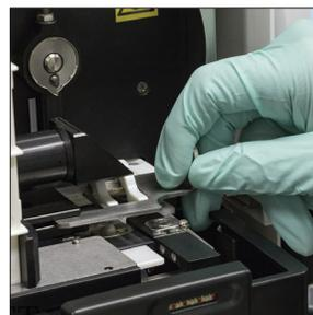
9. Vuelva a colocar el contenedor de residuos, la bandeja de goteo, el protector de la centrifuga y el portador de cartuchos en sus lugares correspondientes en el analizador.
