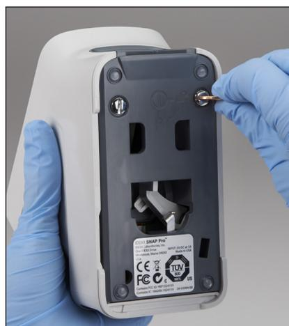
2. Con el analizador apagado, localice los 2 tornillos plateados situados en la cara inferior del analizador y utilice un destornillador de punta plana o una moneda para girarlos un cuarto de vuelta en sentido contrario a las agujas del reloj.
