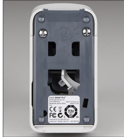
8. Asegúrese de que la base y los tornillos plateados estén a ras del analizador y bien encajados en su sitio. **Si la base o los tornillos no están bien sujetos en su sitio, el rendimiento del analizador puede verse afectado.**
