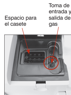
Ilustración 3: Interior de la cámara de medición de muestras
