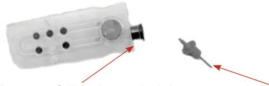
**Figura 16.** Orificio de entrada de la muestra y adaptador de la jeringa
