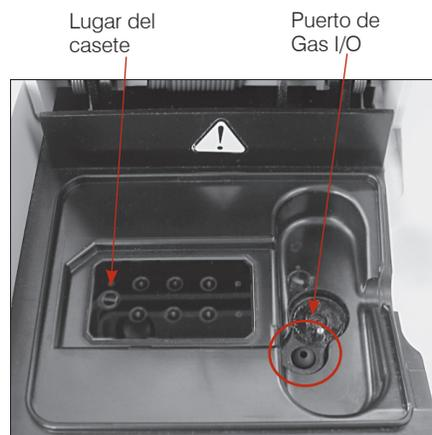
**Figura 27.** Dentro de la cámara de medición de la muestra
