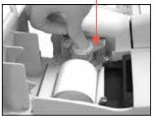
Figure 2: Installer la nouvelle cartouche de la pompe, puis enfoncer le rouleau de la pompe
