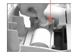
Figura 2: Installare la nuova pompa e spingere il rullo della pompa
